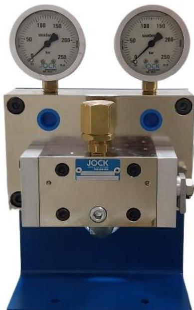
Sistema de linha dupla é basicamente um sistema que trabalha com duas linhas de pressões que se alternam entre si, isto é, nunca ficam pressurizadas ao mesmo tempo.
