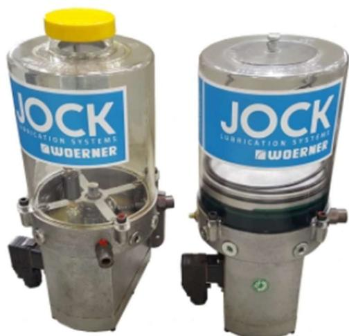
A bomba GMT possui um corpo em alumínio fundido com capacidade para até 8 elementos com saídas independentes. Ela é feita para trabalhar com óleo ou graxa e possui um reservatório em acrílico com capacidade de 2 litros.
